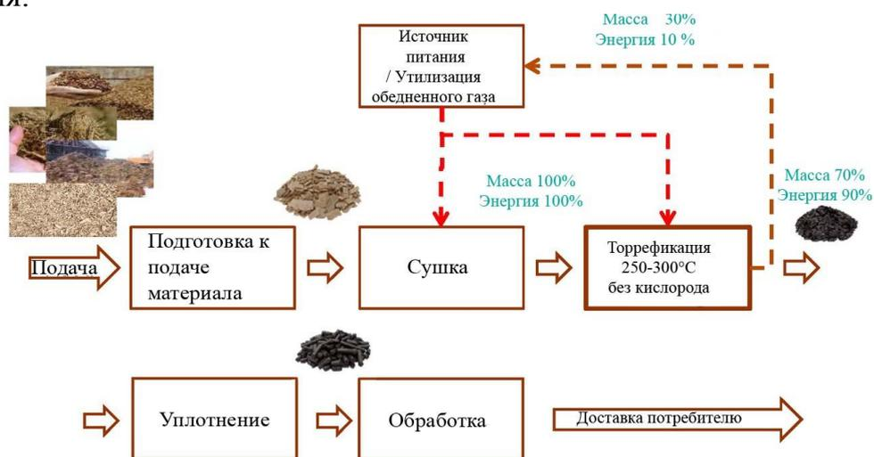
Рисунок 1 – Схема проведения торрефикации
