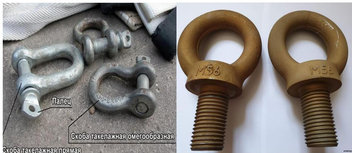
Рисунок 2 – Детали, изготовленные ковкой
