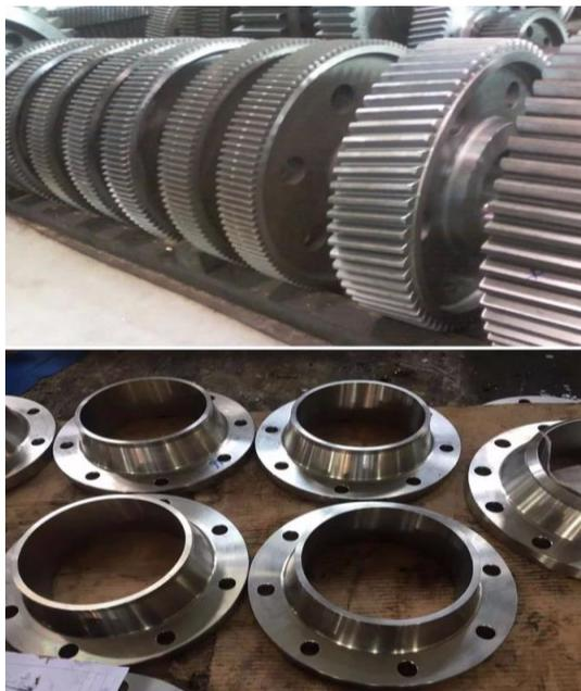
Рисунок 1 – Детали для тракторов, машин и оборудования, изготовленные ковкой
